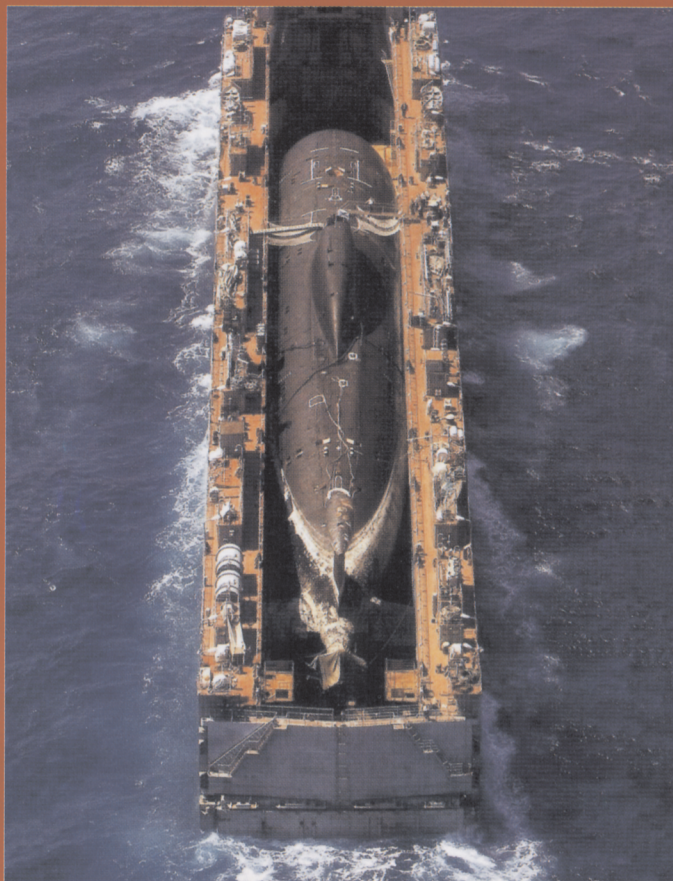
Długość maksymalna 110,3 m, szerokość 13,6 m, zanurzenie średnie 9,7 m. Wyporność pełną źródła rosyjskie podają na 12770 m 3 .
