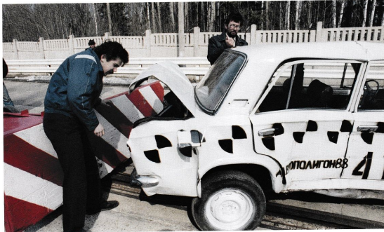
Испытания автомобиля VAZ-21011 на пассивную безопасность методом удара саади на автополигоне НАМИ. 1988 г.
