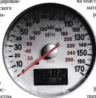
Спидометр со встроенным одометром автомобиля Ford Mondeo ST220.
