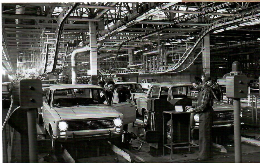
Финальная сборка автомобиля ВАЗ-2101 на Волжском автомобильном заводе. 1972 г.
