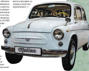
Автомобиль ЗАЗ 965А с двигателем М493-966 мощностью 27 л. с., 1966 года на выставке ретроавтомобилей, 2014 г.
