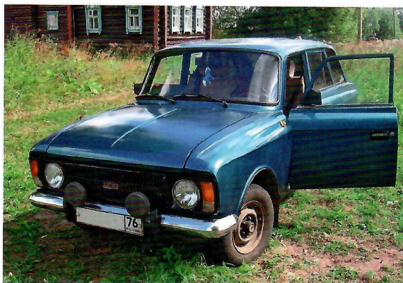
Судя по отсутствию форточек на передних дверях, этот ИЖ 21251-010 был выпущен во второй половине 1980-х годов. 2009 г.
