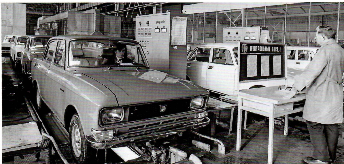
На участке поликонтроля за регулировкой схода колес автомобилей в цехе испытаний. 1977 г.
