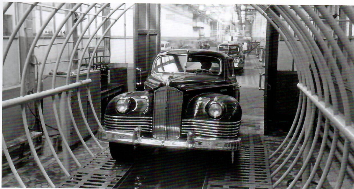
Готовая легковая автомашина «ЗИС-110» в намере для испытаний на водонепроницаемость. Москва. 1958 г.
