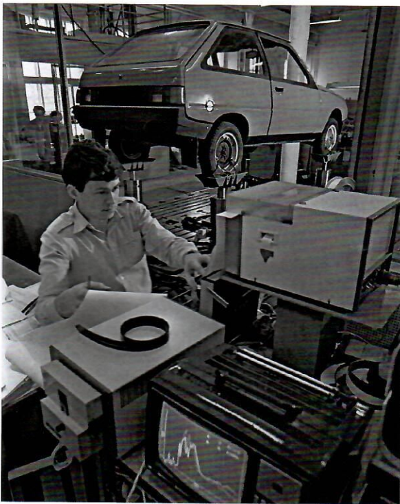
Испытание автомобиля ЗАЗ-1102 на электрогидравлическом стенде. Мелитополь, Украинская ССР. 1988 г.
