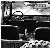
Кабина автомобиля ЛуАЗ-969М. Передние сиденья – раздельные, регулируются в продольном направлении, спинки откидываются назад; задние – единые, откидываются назад, складываются над колесными нишами. 1975 г.
