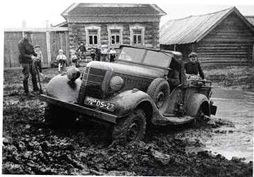
Условия эксплуатации светлых легковых автомобилей заставили конструкторов особое внимание уделять их проходимости. На фото ГАЗ-61-417.
