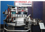
Селевой агрегат легкового автомобиля ЗИС-101 в разрезе. Политехнический музей, Москва. Современная фотография.
