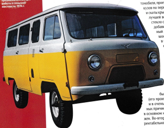
Микроавтобус УАЗ-452В повышенной проходимости, предназначенный для работы в степных местностях, 1974 г.
