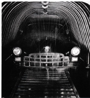
Итак же кузов автомобиля ЗИМ на герметичность. Автомобильный завод им. Молотова, 1955 г.
