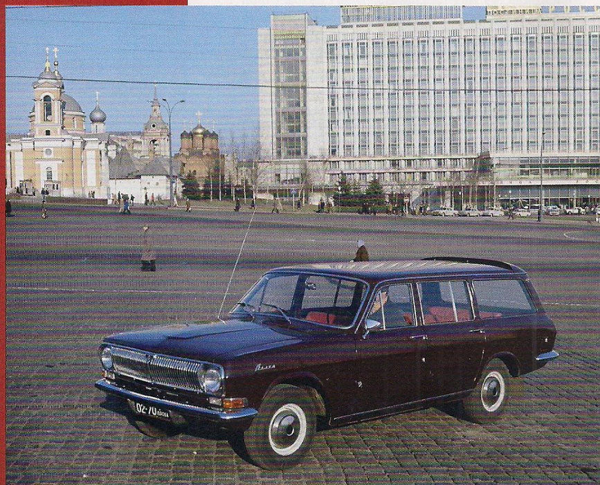
ГАЗ-24-02 Универсал: характерный «гребень» на задней кромке крыши – это не антикрыло, а дефлектор.
