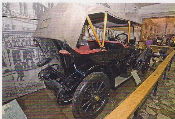
Тип кузова, как у К-12/20, назывался дубль-фаэтон. Он имел два ряда сидений, в отличие от классического двухместного фаэтона.
