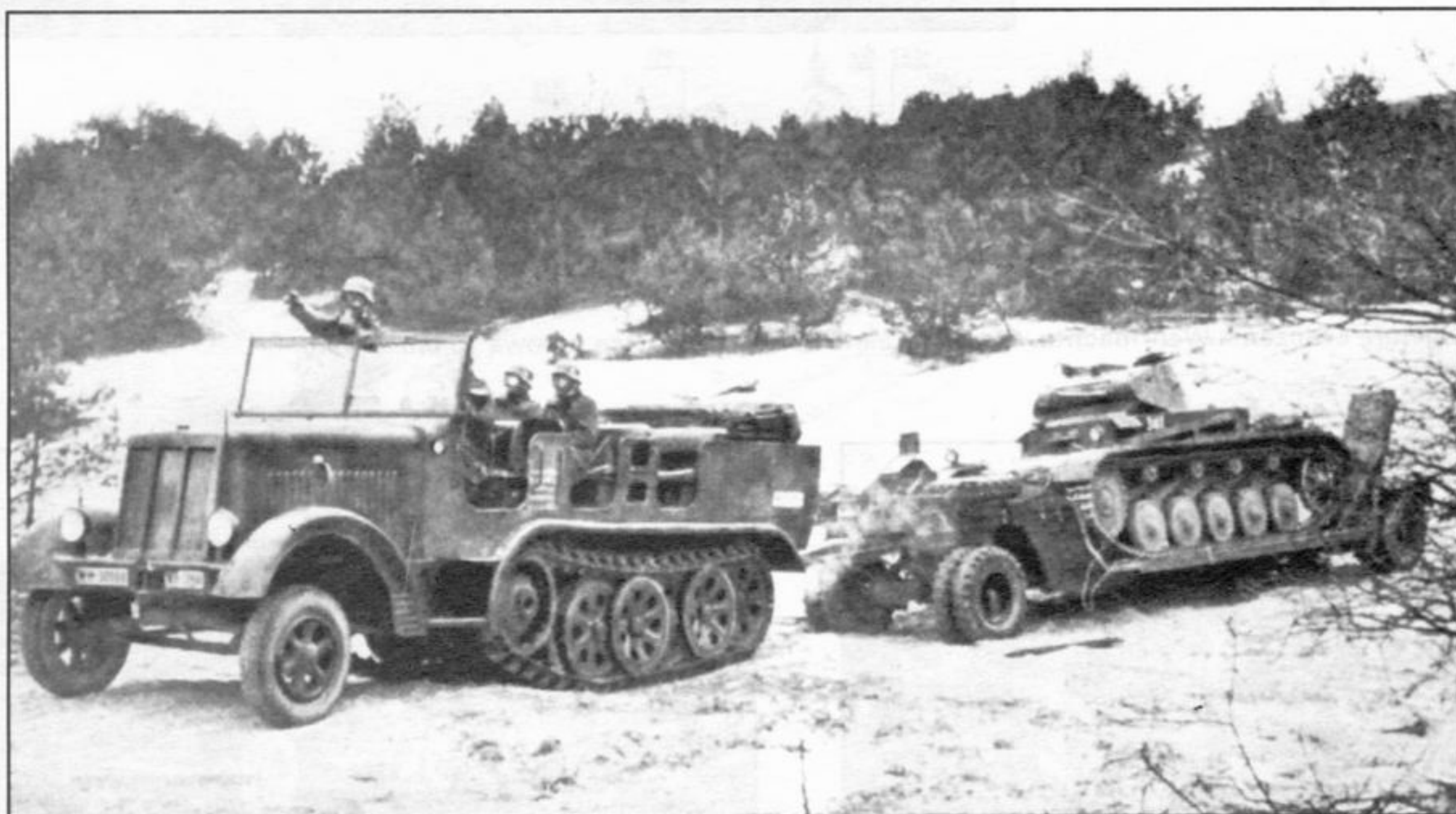
Jeden z prototypów Sd. Kfz. 7. Holowanie platformy z czołgiem w czasie przedwojennych ćwiczeń Wehrmachtu. Na zdjęciu żołnierze „dla ułatwienia” mają założone maski przeciwigazowe.
