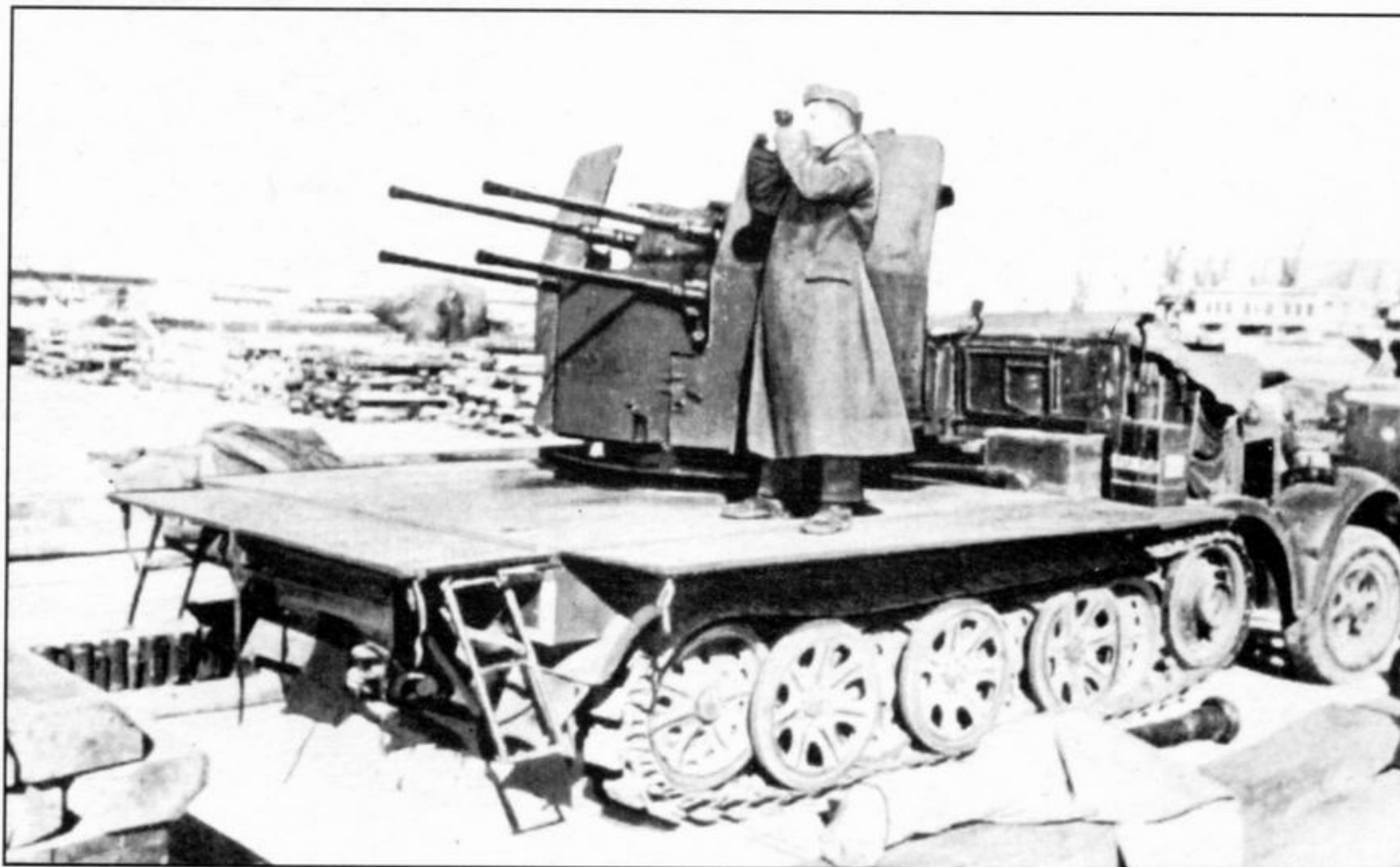
Zestaw p. lot Sd. Kfz. 7/1 w pełnej gotowości bojowej. Opuszczone burty umożliwiają prowadzenie ognia przeciwlotniczego w sektorze 360 stopni.
